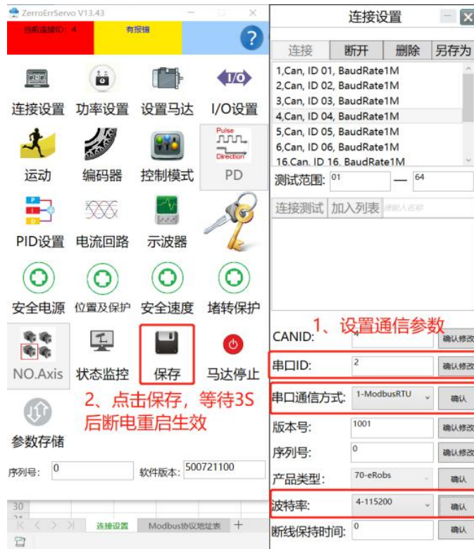
图 3-1 上位机设置 Modbus-RTU 通信参数
